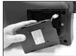
拔除連接線後，更換新電池。紅：(+)正極
